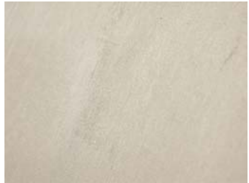
Ett varmbearbetat material får efter avskalning och betning en yta med matt grå färg. Glödskalet som lösgjorts mekaniskt ger en grövre yta.
