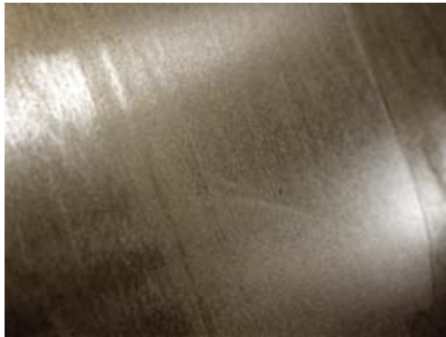
Under varmvalsning eller -formning av rostfritt stål bildas ett gråsvart glödskalet, vilket avlägsnas i tillverkningsprocessen.
