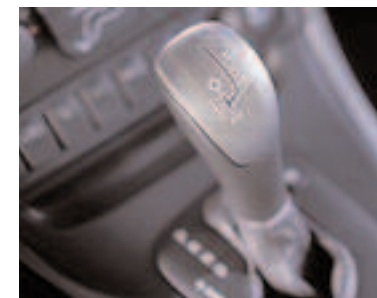
4-steps automat med manuell växlingsmöjlighet – Geartronic (standard i Volvo S80 T6).
